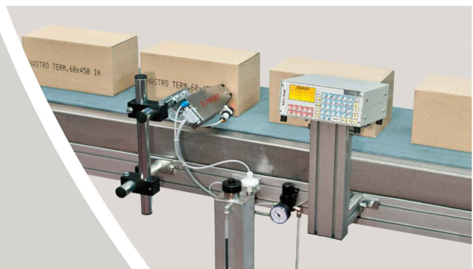
APPLICAZIONE LATERALE CON TESTA KT7 INCLINATA PER RIDUZIONE ALTEZZA CARATTERE
